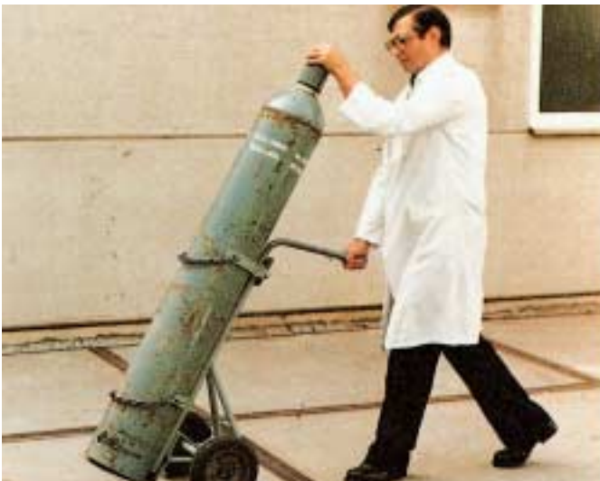
Bild 14: Druckgasflaschen müssen sowohl beim Transport auf den dafür vorgesehenen Wagen als auch am Standort durch Anketten gegen Umfallen gesichert werden.
