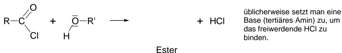
**Versuch:** Herstellung von Essigsäurepentylester aus Acetylchlorid und Pentanol: Geruchsprobe
