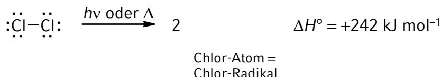
Durch ein Lichtquant oder durch Erhitzen auf über 300°C wird die Energie aufgebracht, um einzelne Chlor-Moleküle ( $\text{Cl}_2$ ) in Chlor-Radikale ( $\text{Cl}\cdot$ ) zu spalten.
