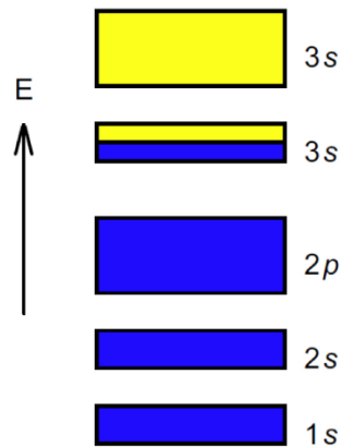
Abbildung 10.15: Schematische Darstellung der Bandstruktur von Natrium. Besetzte Bänder in blau unbesetzte Bänder gelb.
