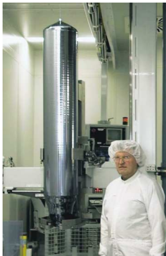
Abbildung 5. Ein Siliciumeinkristall von etwa 2 m Länge, 300 mm Durchmesser und 265 kg Masse, der nach dem CZ-Verfahren gezogen wurde. (Foto: Wacker-Chemie)
