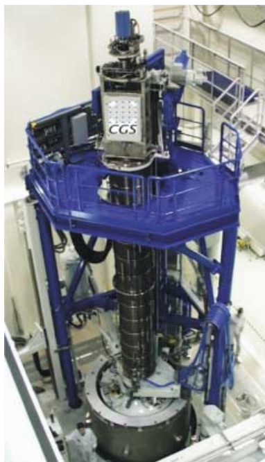
Abbildung 8. CZ-Kristallziehanlage für Tiegeldurchmesser bis 102 cm und maximal 600 kg Siliciumschmelze. [35] (Mit freundlicher Genehmigung der CGS – Crystal Growing Systems GmbH)
